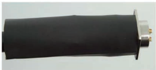
(2) 选择合适的热缩管，套于连接器（电缆）外
