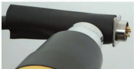
(3) 使用热风机（电吹风）加热热缩管
