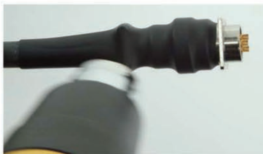
(4) 转动连接器（电缆）或热风机，均匀加热热缩管
