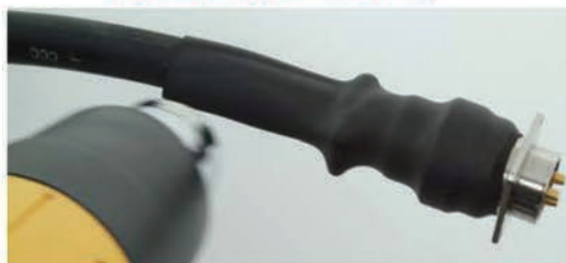
(4) 转动连接器（电缆）或热风机，均匀加热热缩管
